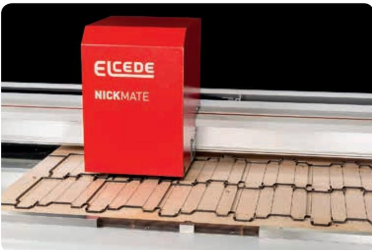
Vollautomatisches Setzen von Haltepunkten in allen Breiten und Tiefen in bereits bemesserte Stanzwerkzeuge
